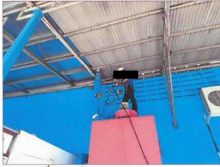
รูปที่ 1 การตรวจวัด Total Suspended Particulate (TSP) บริเวณปล่อง Exhaust (ภายนอก)
