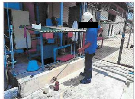
รูปที่ 10 การเก็บตัวอย่างน้ำทิ้ง จาก Outlet
