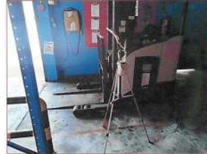
รูปที่ 4 การตรวจวัด Sulfuric acid (H 2 SO 4 ) บริเวณ ชาร์จแบตเตอรี่โฟลคลิฟโฟล์ค
